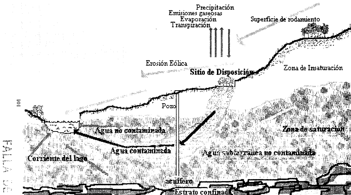
Figura 15. Interacciones ambientales en el sitio de disposición al existir transporte de contaminantes.
