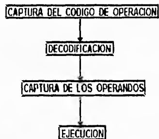
Fig. 2.3 Procesamiento de una instrucción.
