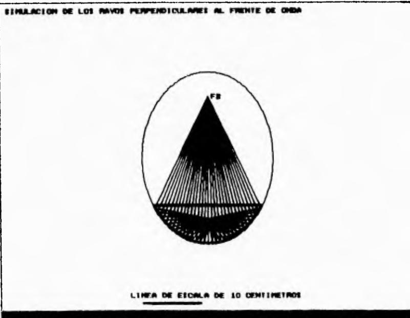
Figura VI.2 Simulación de rayos perpendiculares al frente de onda para semieje mayor "a" = 130.0 mm, semieje menor "b" = 90.0 mm y profundidad máxima "p" = 58.0 mm.
