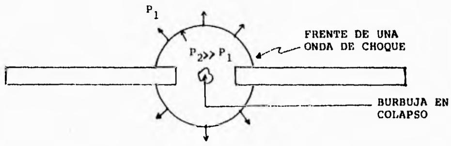
Figura I.2 Descarga eléctrica y generación de una onda de choque en agua.
