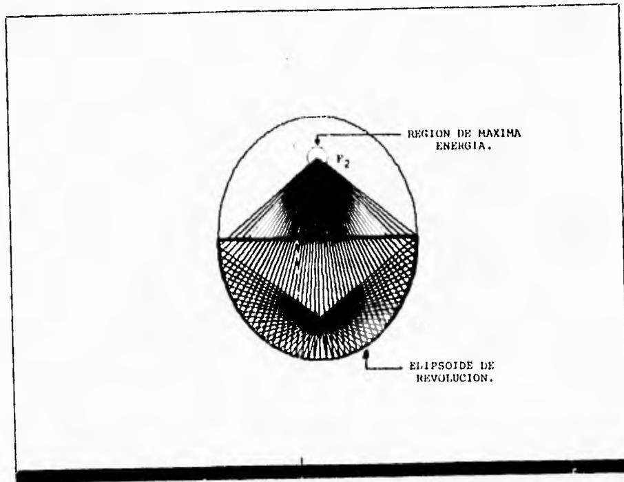
Figura I.3 Diagrama de rayos reflejados en un elipsoide de revolución truncado.
