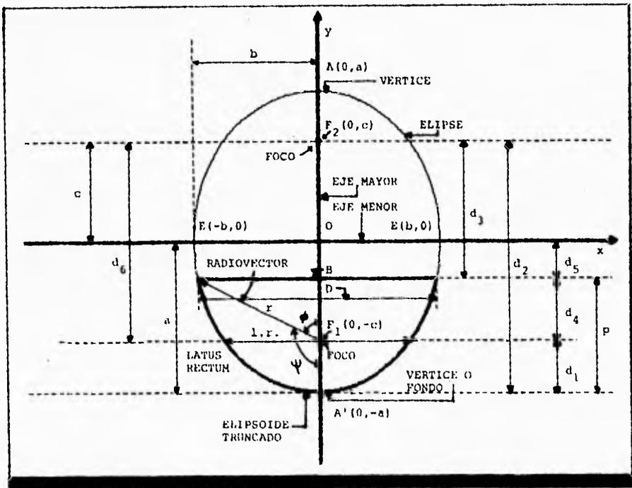
Figura II.1 Corte de un elipsoide truncado con sus parámetros.
