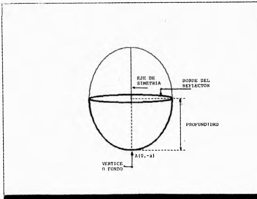
Figura II.3 Profundidad de un reflector elipsoidal.
