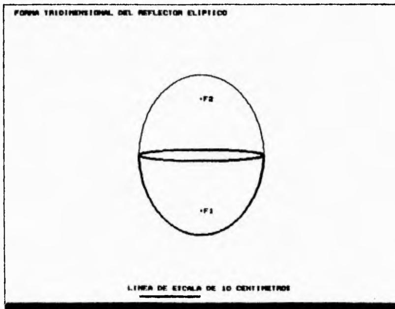
Figura VI.3 Forma tridimensional del reflector para semieje mayor "a" = 120.0 mm, semieje menor "b" = 86.0 mm y profundidad máxima "p" = 120.0 mm.
