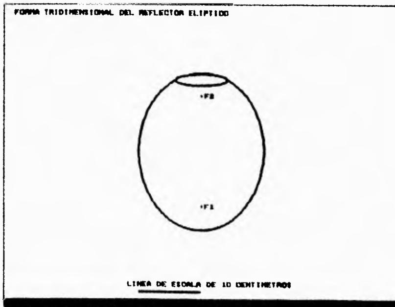
Figura VI.5 Forma tridimensional del reflector para semieje mayor "a" = 120.0 mm, semieje menor "b" = 86.0 mm y profundidad máxima "p" = 228.7 mm.
