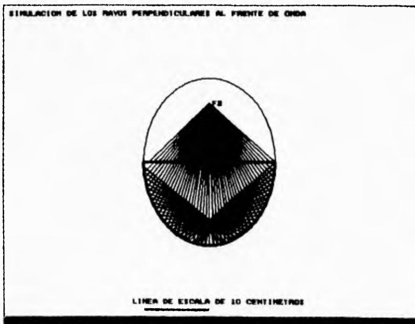
Figura VI.4 Simulación de rayos perpendiculares al frente de onda para semeje mayor "a" = 120.0 mm, semeje menor "b" = 86.0 mm y profundidad máxima "p" = 120.0 mm.
