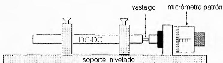
Figura B3 Soporte de calibración del "DC-DC"
