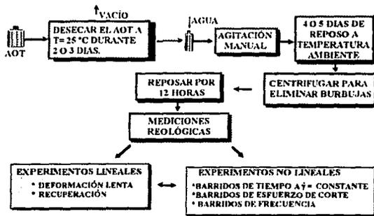
FIGURA 6.1. Procedimiento experimental seguido para la caracterización del sistema Aerosol OT/H<sub>2</sub>O.
