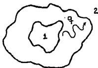
Fig. 4.15 Transferencia de calor por radiación.
