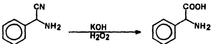
Se realizaron las siguientes pruebas, en las cuales se utilizó KOH al 30 % y se agregó H<sub>2</sub>O<sub>2</sub> (30%) como catalizador en la reacción.
