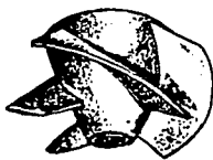
Fig. 1.5 IMPULSORES TÍPICOS: (1)-Abierto (2)-Semiabierto (3)-Cerrado de admisión simple (4)-Cerrado de doble admisión (5)-Abierto (para pulpa de papel) (6)-De flujo axial (hélice) (7)-De flujo mixto
