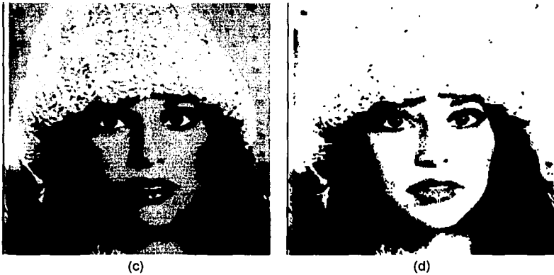
Fig. 3.2 (continuación) (c) resultado del ajuste del contraste; (d) resultado de la imagen umbral.
