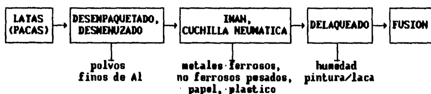
FIGURA 2. DIAGRAMA ACTUAL PARA EL PROCESAMIENTO DE LATAS.
