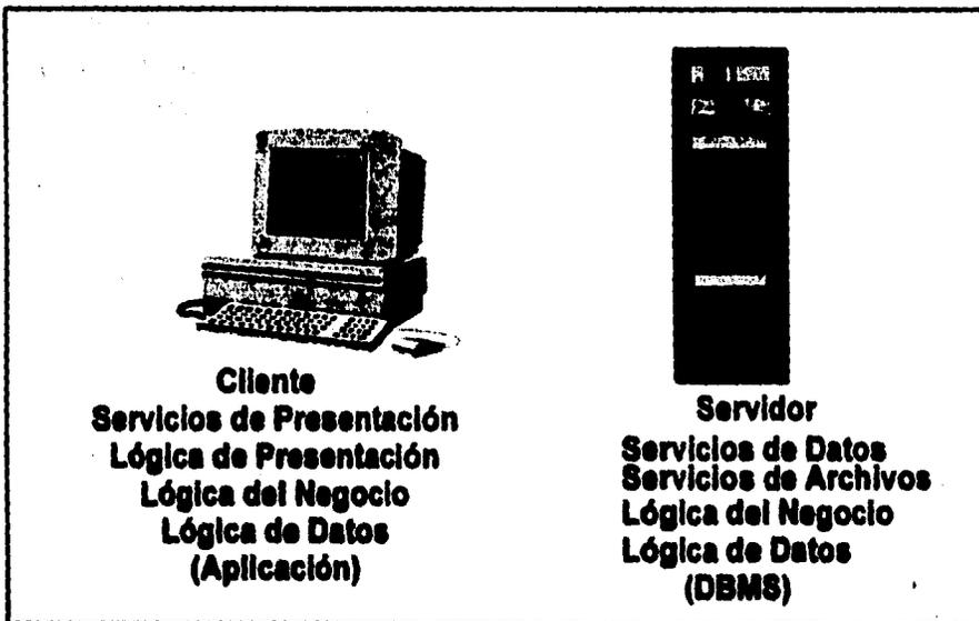
*Figura 3.9. Segunda alternativa de la colocación de los componentes de una aplicación basada en Cliente/Servidor*
