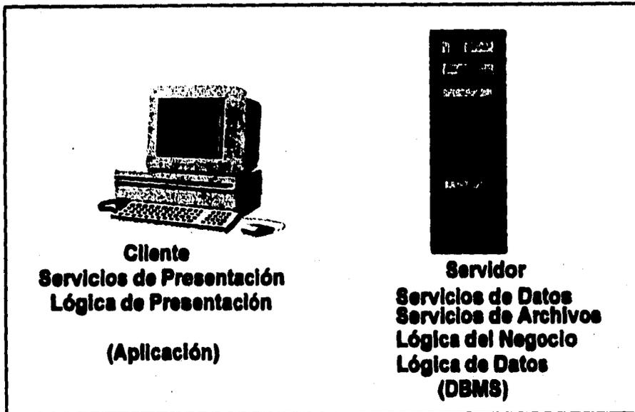
*Figura 3.10. Tercera alternativa de la colocación de los componentes de una aplicación basada en Cliente/Servidor*
