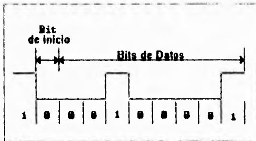
Figura 1.10 Carácter transmitido utilizando ocho bits de datos.
