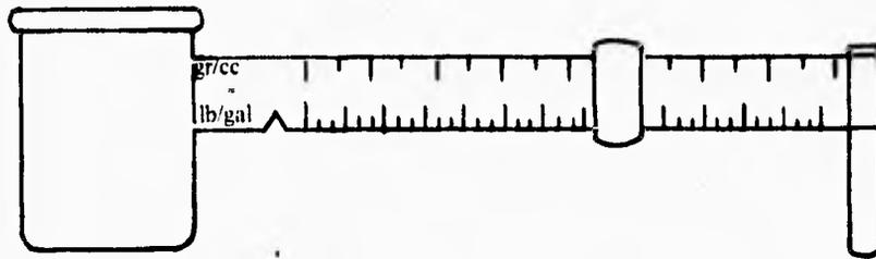
FIGURA 5. Balanza de lodos.
