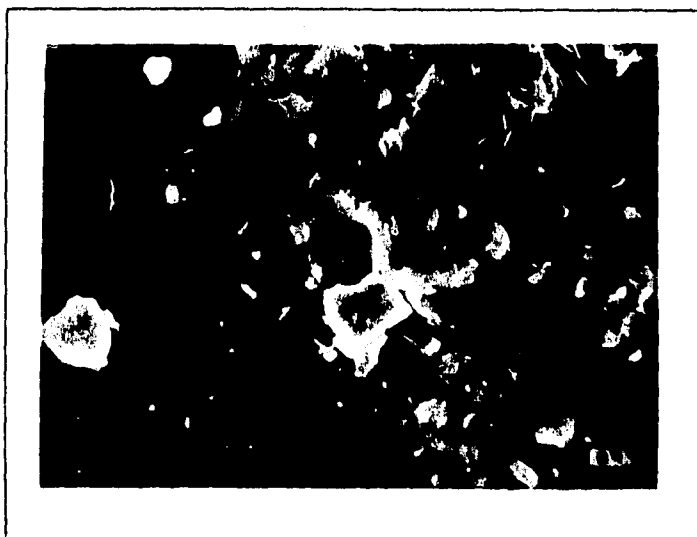
Figura 4-19 e. Muestra con 15% de fécula, 500 h de radiación, 32 RPM, 750X.
