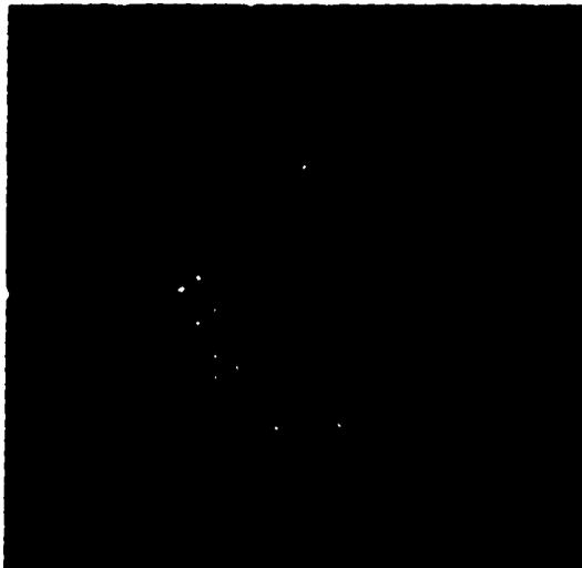
**Fig. 9b** Sustracción de la fig. 9a a la imagen original para obtener los picos realzados.
