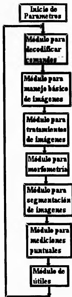
Fig 2.2 Estructura lógica de cada uno de los módulos que forman BIOCROM.
