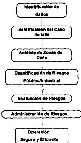
Gráfica. 1.1.- Panorama de la Metodología de Evaluación de Daños Y Análisis de Riesgos
