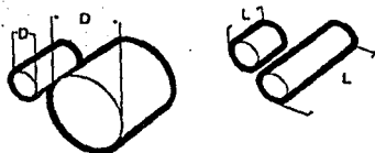
Fig. 2.3 La resistencia de un alambre depende de su longitud y diámetro
