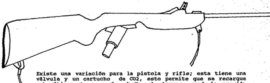
Existe una variación para la pistola y rifle; esta tiene una válvula y un cartucho de CO2, esto permite que se recargue automáticamente y según el No. de barras, será la presión ejercida (7).
