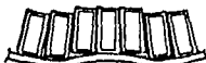
CORRECCION CON CALZAS DE CABALLETE HACIENDO MAS SOLIDA LA UNION ENTRE LADRILLOS
