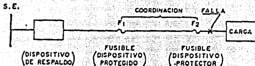
FIGURA 4-11 COORDINACION FUSIBLE-FUSIBLE
