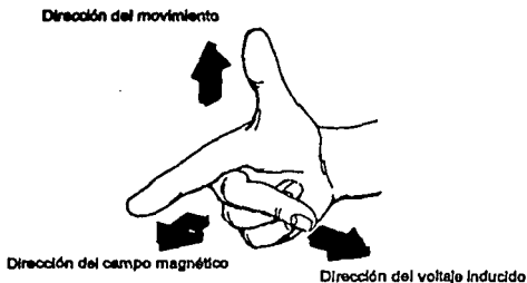
Fig (3.5) Relación de Fleming de la mano derecha para conocer la polaridad del voltaje inducido en un conductor.
