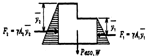
c) Diagrama de cuerpo libre del volumen de control
