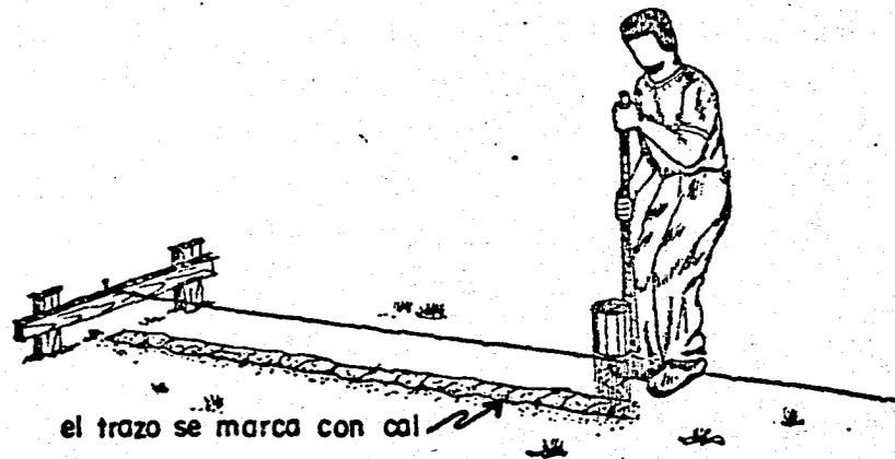
LA EXCAVACION DE LAS CEPAS DONDE SE COLOCARAN LAS DALAS DE LIGA C-1 Y C-2, DEBEN TENER 16 CM., DE PROFUNDIDAD.
