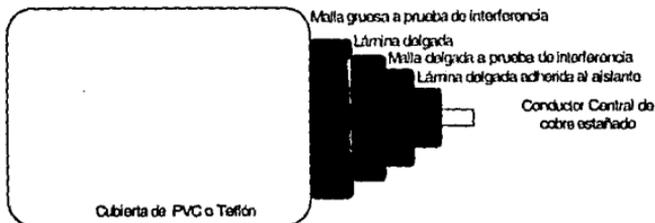
Figura 1.4. Estructura del cable coaxial grueso.
