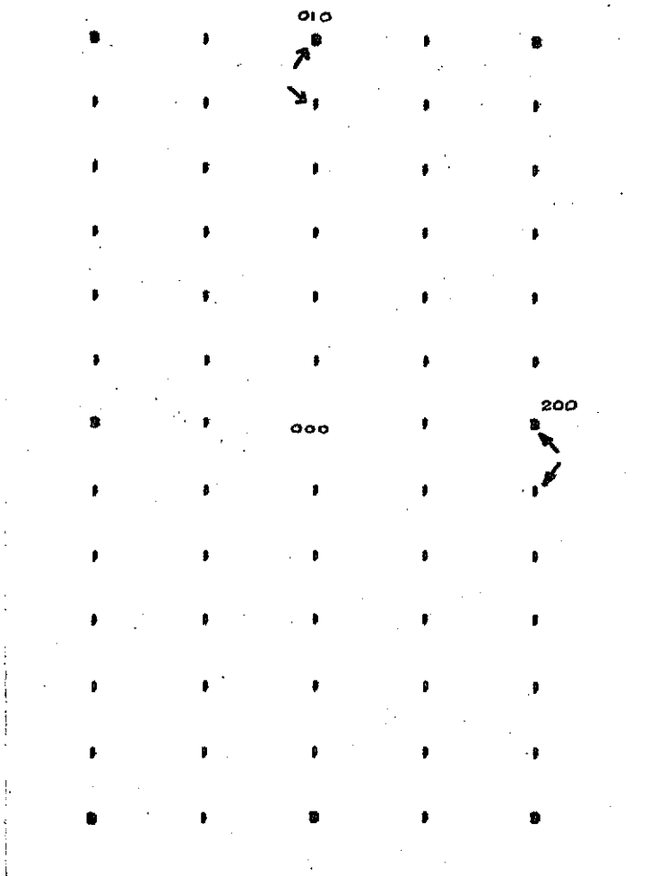
Figura 2.2.-Patrón de difracción dinámico, simulado en la computadora, de la partícula en forma de escalera de la figura 2.1. Obsérvense las 6 reflexiones extras (que corresponden a los 6 escalones de 2.1). Las intensidades de los puntos extras son 4 veces menores que las de los puntos normales (el (200), por ejemplo).
