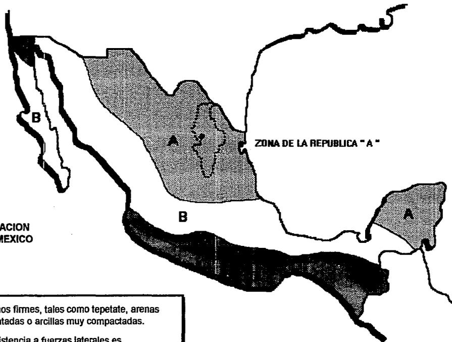
**TIPO DE SUELO I.-** Terrenos firmes, tales como tepetate, arenas cementadas o arcillas muy compactadas.
