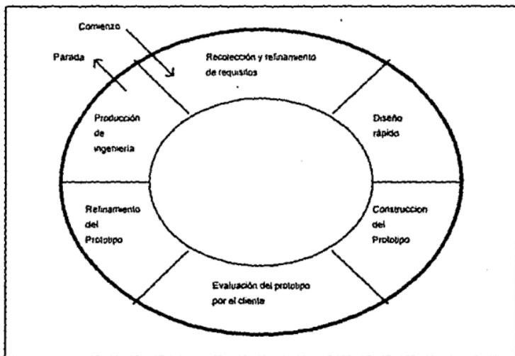
Figura. 1.2.- Modelo de Creación de prototipos
