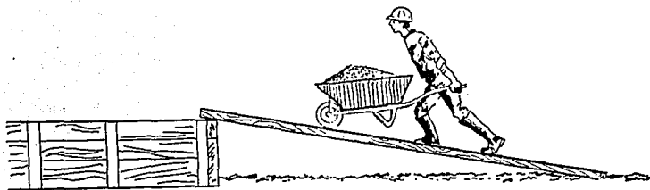
FIG. (5). Colado Mediante Carretilla.
