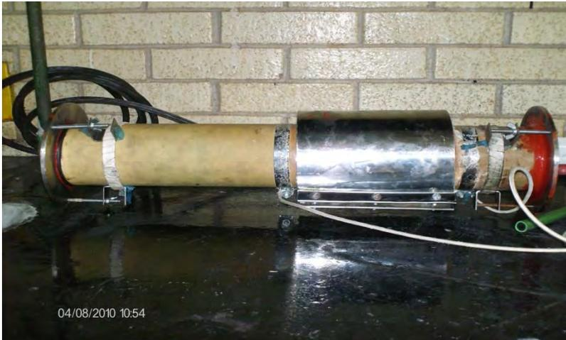
**Ilustración 1 Horno de resistencia eléctrica**
