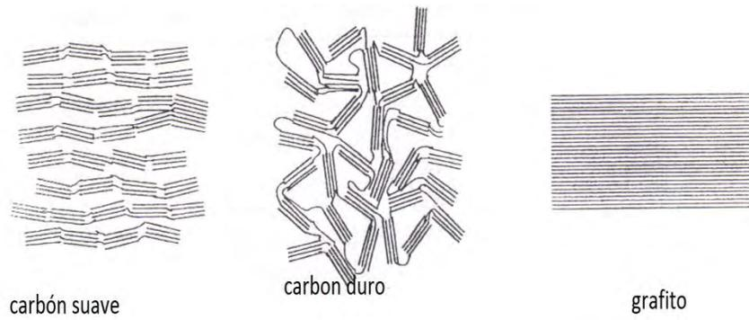
Figura 7 (Muestra los distintos tipos de carbones utilizados en baterías ion-Litio) [1]
