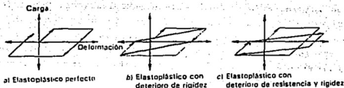
FIGURA 6.5, Ciclos de histéresis de sistemas con diferentes tipos de comportamiento inelástico
