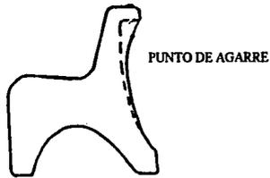
**Posición horizontal de la silla** .- La silla en el respaldo tiene una reducción para facilitar el agarre, ( punto A) la otra mano se posiciona en el punto B y posteriormente se gira hasta adoptar la posición horizontal.
