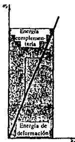
FIGURA II-6. Diagrama esfuerzo-deformación de un elemento sometido a carga.
