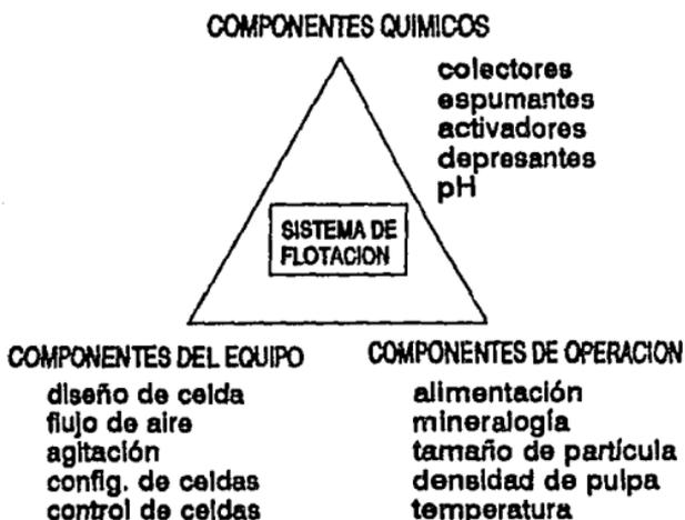
Fig. 1.- Sistema de flotación con sus tres subdivisiones
