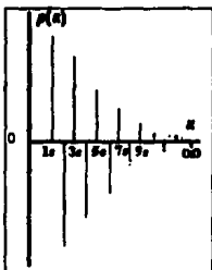
Gráfica del Correlograma Teórico para el modelo AR s (P)
