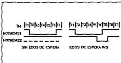
FIGURA 4.5 EJEMPLOS DE CONFIGURACION DE TIEMPOS DEL TRANSPUTER
