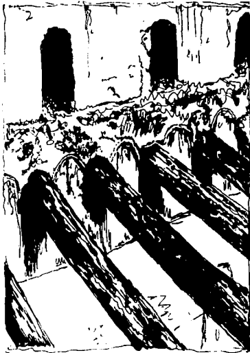
Casa del Adelantado Francisco de Montejo. Sistema constructivo de morillos empotrados sobre viga de arrastre. Cuadernos de Arquitectura Virreinal. UNAM. FA. I.
