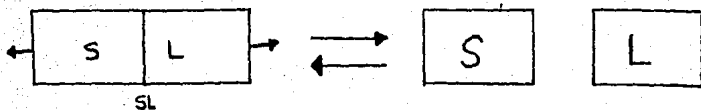
fig. 4.3) Trabajo de adhesión (s: sólido y l: líquido sl: interfaz sólido líquido)
