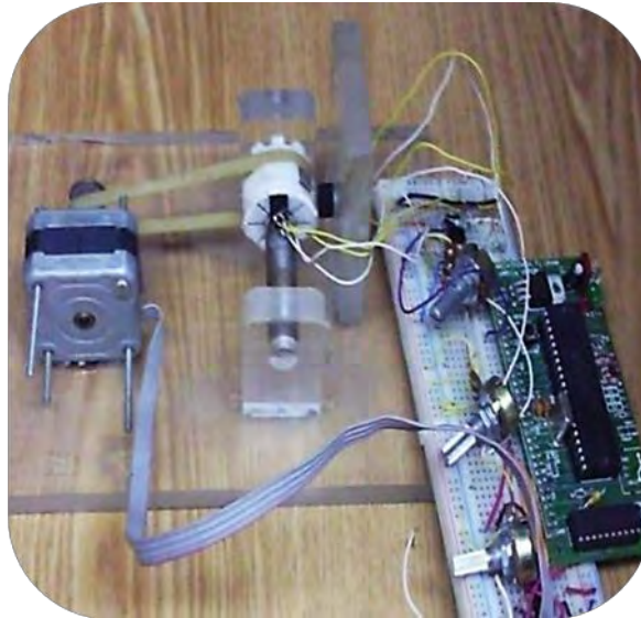
Figura 2.16 Mecanismo de octágono para impresión de caracteres braille.
