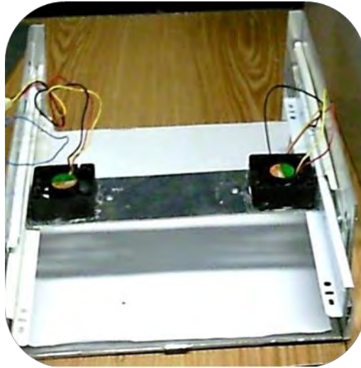
Figura 2.15 Ventiladores para mover las hojas.
