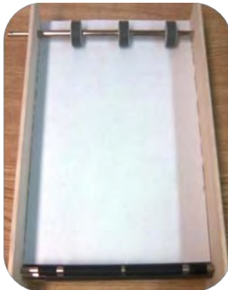
Figura 2.13 Un eje de rodillos a la entrada y dos ejes de rodillos a la salida.
