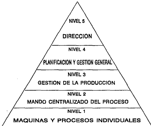
Figura 5.4.2 Sistema automatizado en forma piramidal.
