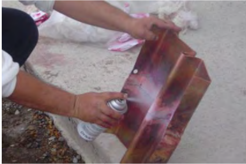
Fotografía 7.2.1-1. Aplicación de la mezcla reveladora. Cortesía I.C.A.
