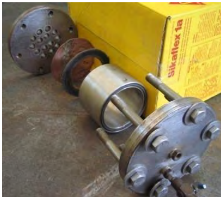
Fotografía 7.2.3-1. Cámara de presión donde se coloca la muestra de cobre. Cortesía I.C.A.
