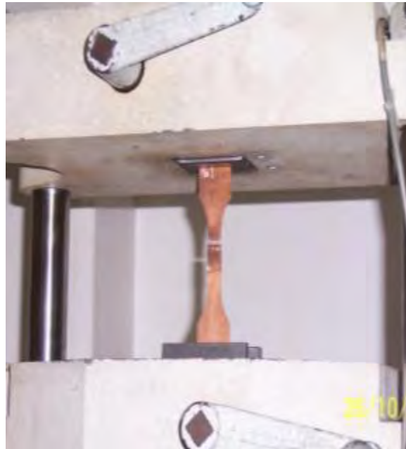
Fotografía 7.2.2-3. Probeta colocada en el marco de carga. Cortesía I.C.A.
