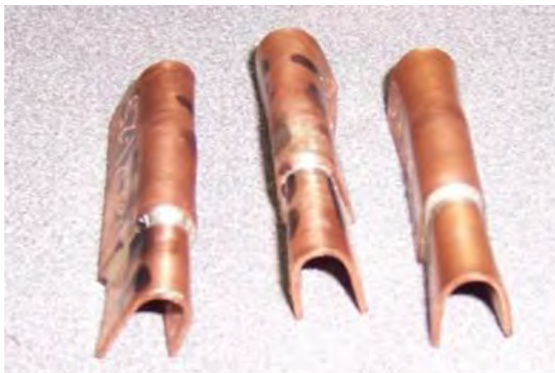
Fotografía 7.2.2-8. Probeta de cobre despues de la prueba de doblado. Cortesía I.C.A.
