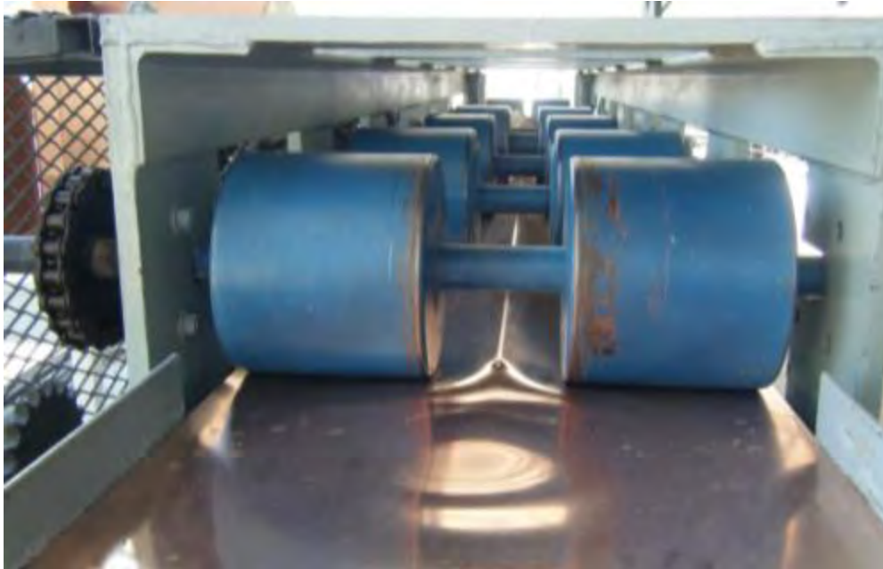
Fotografía 6.3.1-3. Lamina en proceso de rolado.
