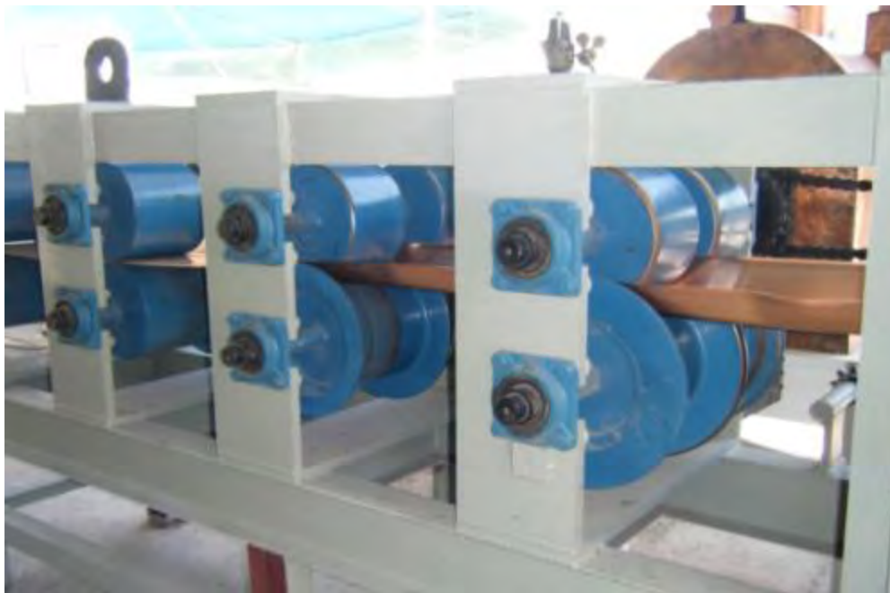
Fotografía 6.3.1-4. Lamina en proceso de rolado.
