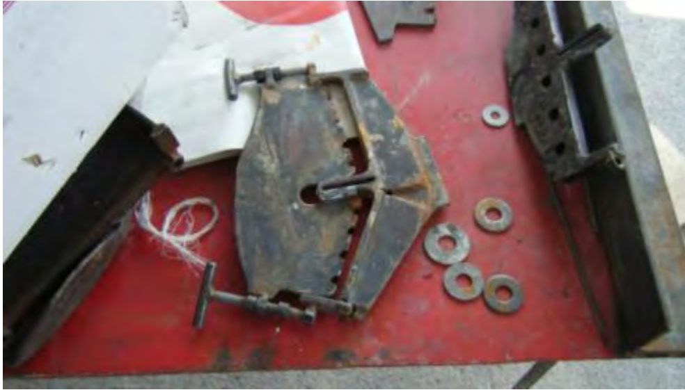
Fotografía 6.4-1. Prensa diseñada para la unión de piezas de cobre.
