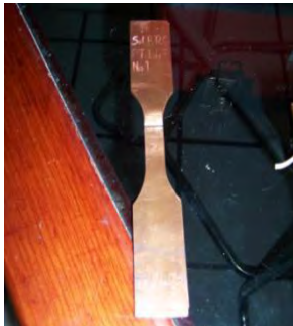
Fotografía 7.2.2-2. Probeta de cobre para ensayo de tensión. Cortesía I.C.A.
