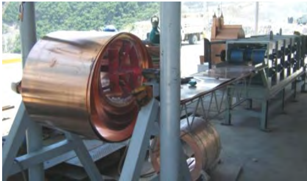
Fotografía 6.3.1-2. Lamina de cobre entrando a la roladora para obtener la forma del sello.
