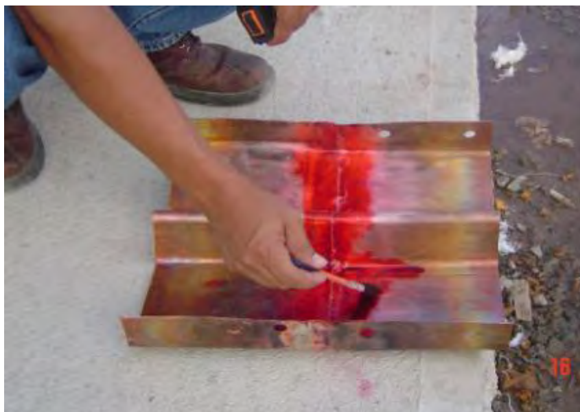
Fotografía 7.2.1-1. Colocación de líquidos penetrantes. Cortesía I.C.A.
