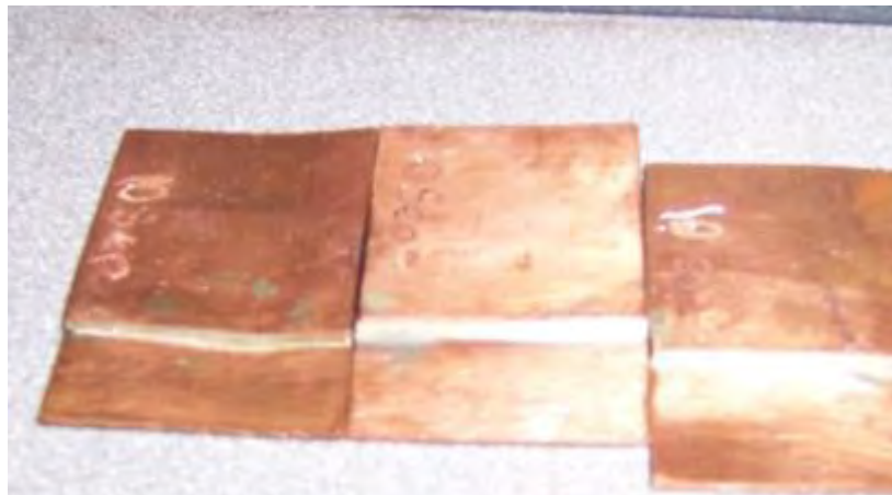
Fotografía 7.2.2-6. Probetas de cobre para prueba de doblado. Cortesía I.C.A.
