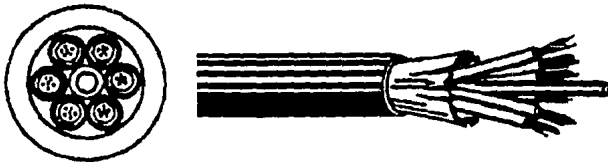
Figura 2.13 Fibra óptica para aplicaciones exteriores de tipo aérea.
