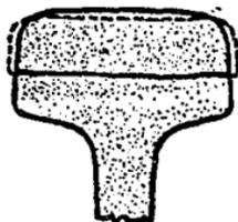
Otro defecto en el riel es la grieta vertical en el hongo. Esta es localizable antes de que cause perjuicio al riel. Como los defectos anteriores, se origina con pequeñas grietas interiores que aumentan con la acción del tráfico.
