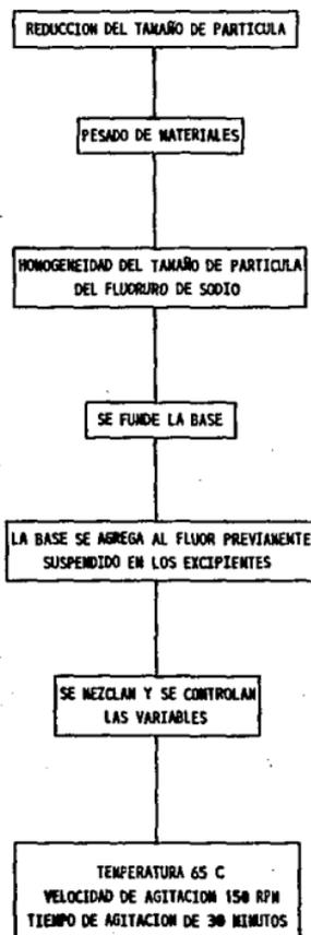
FIGURA 1. Diagrama de flujo del proceso de elaboración del barniz con flúor.
