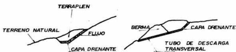
C.- TRINCHERA INTEGRADA AL TERRAPLEN.
