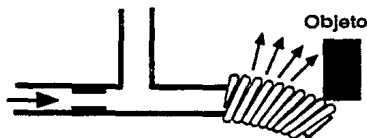
fig 9 Escapa el aire al doblarse el resorte con el objeto
