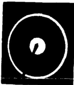
Fig 17. Patrón de difracción de un amorfo
