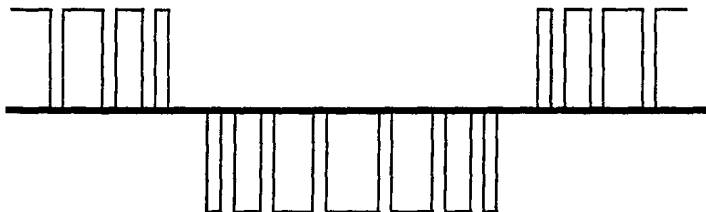
figura 3.3 Señal modulada en anchura de pulsos
