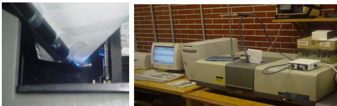
Figura 3.2. La fibra óptica de la lámpara dental es acoplada al espectrofotómetro FTIR para obtener las señales de transmitancia de las muestras después de enviar el pulso de luz.
