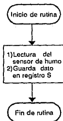
Fig. 5.3 Subrutina de lectura del sensor de humo.
